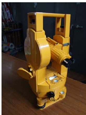
รูปภาพที่ ๑๙ แสดงกล้องวัดมุมแบบอ่านค่าโดยระบบแสง ที่มา: นายชาติชาย ฉัตรทอง. (๒๕๖๓). การสำรวจด้วยกล้องวัดมุม.
